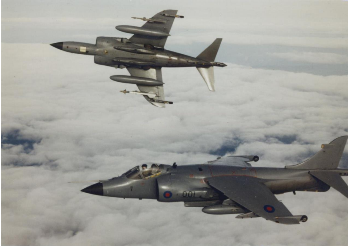
Dos British Aerospace Sea Harrier FRS.1 del Escuadrón Aeronaval 801 (con base en el HMS Invincible ) en patrulla de combate sobre Malvinas. Un misil AIM-9L Sidewinder es claramente visible en el avión más alejado de la cámara.
